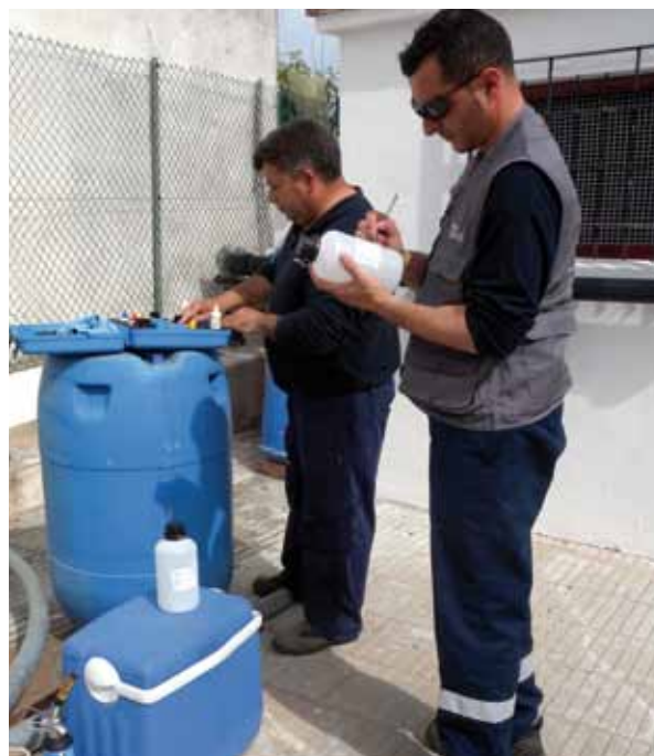
Un tècnic de l'empresa proveïdora del servei, Prodaisa, es prepara per agafar mostres de l'aigua del dipòsit municipal de Vidreres.
