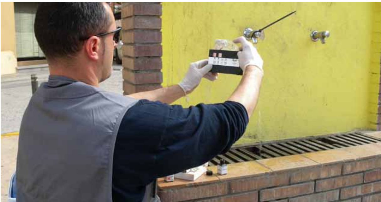
Comprovant els nivells de clor i PH de la font, connectada a la xarxa, de la plaça 11 de setembre de Vidreres.
